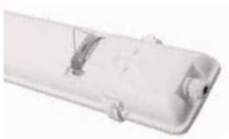
В корпусах светильников из поликарбоната (PC) не допускается высверливать или выдалбливать отверстия для крепления на несущую поверхность. Крепление производится защелкиванием корпуса в пластину (арт. 01846), которая крепится на несущую поверхность. Для подвеса светильников используется элемент подвеса (арт. 01853), который защелкивается в пластину (арт. 01846). Пластина (арт. 01846) и подвес (арт. 01853) входят в комплект поставки светильника из поликарбоната (PC).
