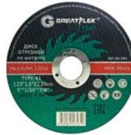
Диск абразивный отрезной Greatflex LIGHT предназначен для разрезания различных сталей и сплавов. Производятся диски на основе нормального корунда с помощью бакелитовой связки, что обеспечивает высокий КПД. Использована уникальная технология производства Cutop. Для УШМ.
