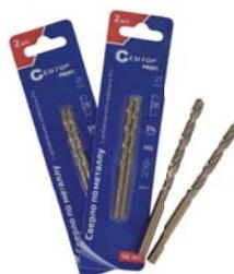
Профессиональное сверло по металлу CUTOP Profi с добавлением кобальта 5% для профессионального использования. Класс точности A1. Цилиндрический хвостовик. Угол заточки 135°. Предназначено для сверления отверстий в углеродистых и легированных сталях, серых и ковких чугунах, цветных металлах и пластике. Материал: Быстрорежущая HSS сталь с добавлением кобальта 5% (P6M5K5). Упаковка: блистер.
