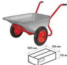
Двухколесная. Грузоподъемность 260 кг. Объем: 110 л. Рама из крашеной стальной трубы диаметром 32 мм. Тип кузова: полиуретановое. Диаметр колеса: 360 мм. Посадочный диаметр колеса 25,4 мм. Колеса, рама и крепеж упакованы в картонную коробку. Может использоваться с колесами 77623, 77633.
