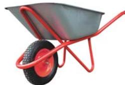
Рама из крашеной стальной трубы 32 x 1,2 мм. Тип кузова: стальной оцинкованный. Тип колеса: полиуретановое, литое. Диаметр колеса: 380 мм. Посадочный диаметр колеса: 16 мм. Может использоваться с колесом 77559, 77565, 77585, 77621, 77622, 77625, 77631, 77635.
