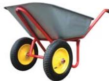
Двухколесная. Грузоподъемность: 240 кг. Объем: 110 л. Рама из крашеной стальной трубы 32 x 1,2 мм. Тип кузова: стальной оцинкованный. Тип колеса: пневматическое, с камерой. Диаметр колеса: 360 мм. Посадочный диаметр колеса: 25,4 мм. Может использоваться с колесами 77623, 77633.
