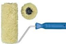
D 40/76 мм, ворс 18 мм, бюгель 6 мм. Для полуглянцевой и грубой поверхности. Система с пластиковым роликом. Для лаков из искусственных смол, водорастворимых лаков, вододисперсионных, латексных масляных красок.
