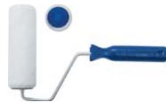
D 42/50 мм, ворс 4 мм. Бюгель 6 мм. Каркасная система. Для гладкой поверхности. Используется с лаками и другими защитными покрытиями на основе растворителя.
