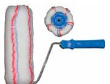
D 48/84 мм, ворс 18 мм. Бюгель 8 мм. Система с пластиковым роликом. Для полуглянцевой и грубой поверхности. Используется с вододисперсионными и масляными красками.
