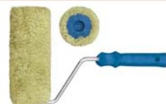
D 58/94 мм, ворс 18 мм. Бюгель 8 мм. Для полуглянцевой и грубой поверхности. Система с пластиковым роликом. Используется с вододисперсионными и масляными красками.
