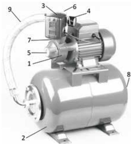
Вихревого поверхностного насоса (1), гидроаккумулятора емкостью 24 л (2), реле давления (3) и манометра (4). Насос имеет входное (5), выходное (6) и заливное (7) отверстия. Гидроаккумулятор имеет во внутренней полости EPDM-мембрану и пневмоклапан (8) для регулировки давления воздуха. Насос и гидроаккумулятор соединены шлангом (9).
