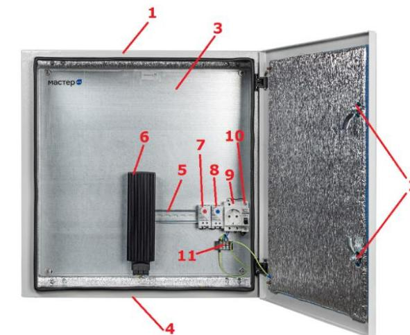
**Внимание!** Температура корпуса обогревателя во время работы превышает 70°C, во избежание повреждения аппаратуры и кабелей производите их монтаж на расстоянии не менее 20 мм от обогревателя.
