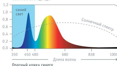
и провалы в области сине-бирюзового (480 нм) и красного (680 нм) цветов. Спектр света, который излучают лампы Navigator Supervision не содержит избыточное количество синего света и не провоцирует проблем, ассоциированных с пиками и провалами в области синего цвета в традиционных светодиодных лампах.
