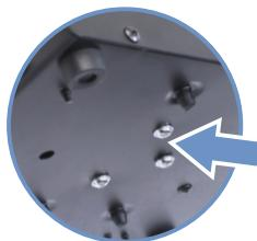
**ВАЖНО!!!** Выкрутите 3 блестящих транспортировочных винта на дне станции. Винты фиксируют компрессор к корпусу станции для исключения повреждения амортизаторов компрессора. Сохраните винты – чтобы установить их для последующей транспортировки паяльной станции
