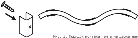
Рис. 3. Порядок монтажа ленты на держатели
