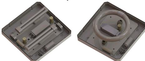
5. Установити розсіювач на корпус світильника
