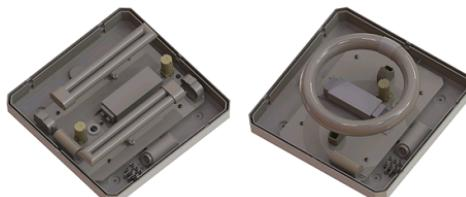
5. Установить рассеиватель на корпус светильника.
