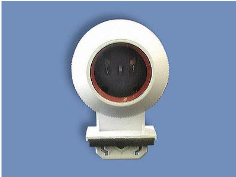
Патрон (ламподержатель) герметичный G13 для люминесцентных ламп Т8, одиночный IP67 (водо- и пылезащищенный) с прижимной муфтой под лампу  $\varnothing$  26мм в сборе (крепление на защелки), серый
