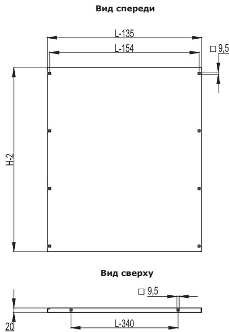
Внутренняя дверь для модульного оборудования
