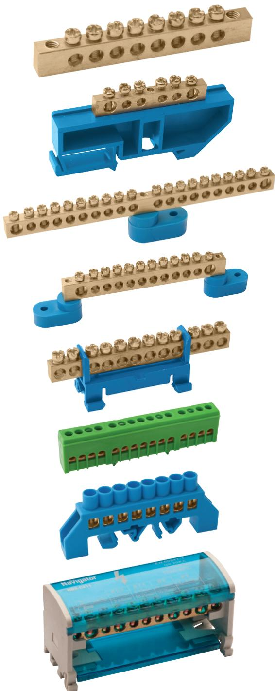
Нулевые шины Navigator серии NBV предназначены для электрического и механического соединения нулевых рабочих (N) и нулевых защитных (PE) проводников. Область применения: электрощитовое оборудование и электроустановки с напряжением до 400 В.
