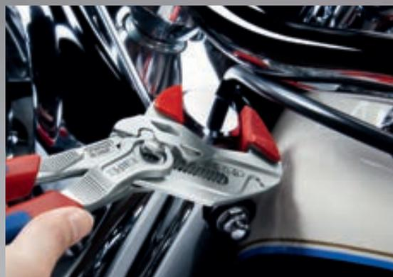
Защитные губки позволяют работать с деликатными поверхностями
