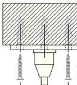
1. Просверлите отверстия в потолке. Для определения положения отверстий используйте круглую оконцовку тросса.
