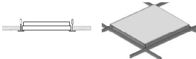
5.4 Накладной монтаж светильников осуществляется на ровные потолки из любого строительного нормально воспламеняемого материала. В потолке должно быть предусмотрено отверстие для проводов питания светильника. Светильники должны быть надежно зафиксированы на поверхности при помощи саморезов (нет в комплекте поставки). Рассеиватель закрепляется по окончании монтажа светильника на поверхность:
