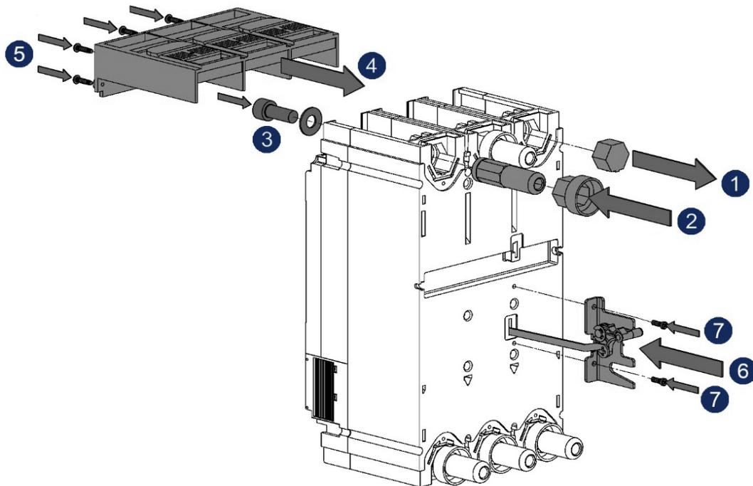
Выключатель должен находиться в положении автоматического отключения
