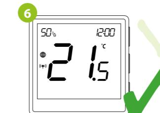
Устройства успешно сопряжены. Регулятор отображает главный экран, на экране появилась иконка «(•)», сигнализирующая о связи с приемником.
