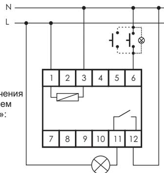
Схема подключения с управлением от нуля «N»:
