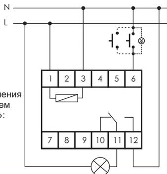
Схема подключения с управлением от нуля «N»:
