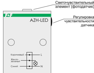
Автомат светочувствительный AZH-LED выполнен в корпусе A8 для крепления на плоскость. С правой стороны от лицевой панели находится регулятор чувствительности датчика. Сверху от лицевой панели находится светочувствительный элемент (фотодатчик).
