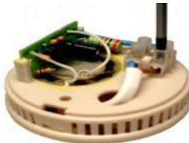
4. Присоедините провода (1) к клемной колодке звонка, предварительно отключите в технологические провода.
