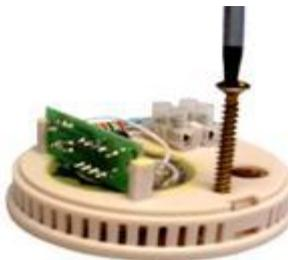
3. Закрепите звонок шурупами к стене или панели. Будьте внимательны и осторожны чтобы не повредить сетевые провода проводки или звонка.
