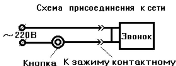
Места присоединения звонка к электрической сети должны быть выполнены так, чтобы исключить возможность короткого замыкания между проводами, отделения провода от зажима или повреждения шнура. Звонок шурупами закрепить на стене.
