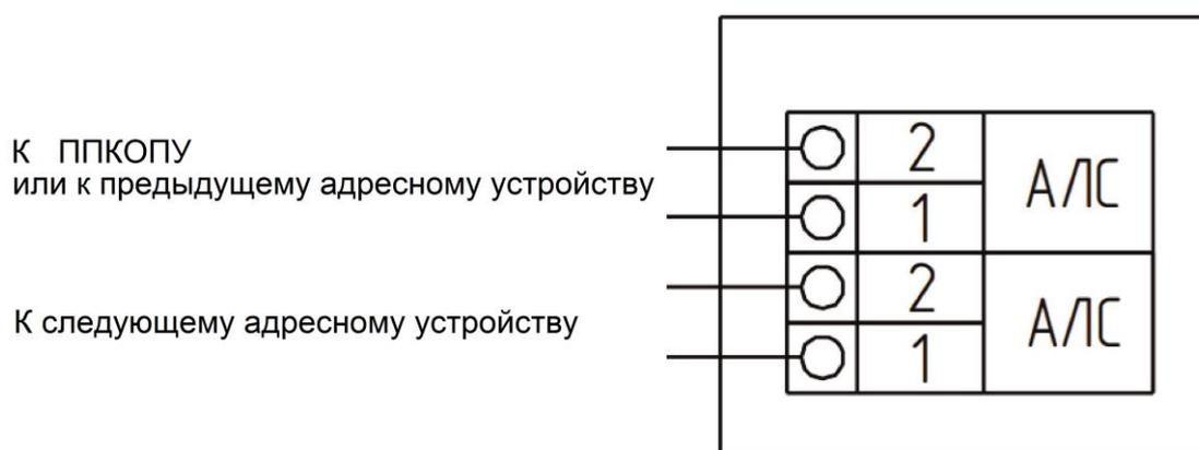
Рисунок 2 - Схема соединения извещателя с ППКОПУ
