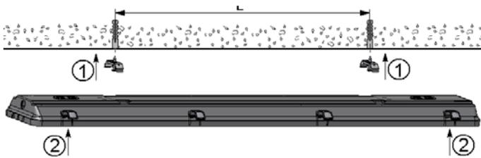
Для светильника ARCTIC: просверлить установочные отверстия на поверхности потолка и в корпусе светильника на расстоянии L.
