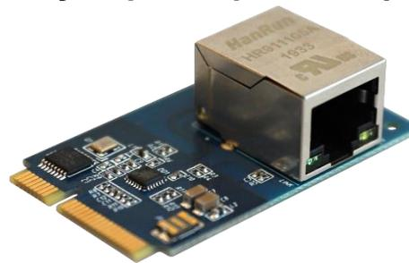
служит для сетевого подключения модуля управления к маршрутизаторам в случае невозможности организации беспроводного подключения к сети Wi-Fi.
