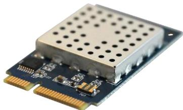
предназначен для организации соединения с беспроводными датчиками контроля протечки воды Neptun Smart 868. Посредством радиомодуля можно подключить до 50 беспроводных датчиков протечки воды.
