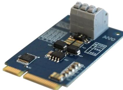
служит для применения в системах диспетчеризации с поддержкой протокола Modbus RTU.
