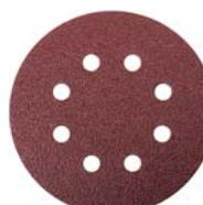
8 отверстий. На тканевой основе с «липучкой». Диаметр 125 мм, набор 5 шт. Для обработки различных материалов. Материал: х/б основа, абразивный слой - оксид алюминия. Упаковка: пластиковый конверт.
