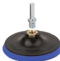
С липучкой. Используется со шлифовальными и полировальными кругами. Гайка М14 для установки на шлифовальные и отрезные машины. В комплекте переходник со штифтом для крепления на дрель. Материал: инструментальная сталь, пластик, подложка из ЭВА. Упаковка: п/э пакет с картонным подвесом.
