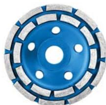
Два ряда сегментов. Для использования с УШМ. Посадочный диаметр 22,2 мм. Для устранения неровностей, зачистки и шлифовки бетона, камня, кирпича и аналогичных строительных материалов. Материал: инструментальная сталь, режущая кромка - расправ с техническими алмазами. Упаковка: блистер.
