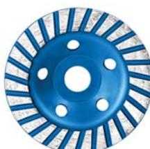
Сегментный «Турбо». Широкие сегменты. Для использования с УШМ. Посадочный диаметр 22,2 мм. Для устранения неровностей, зачистки и шлифовки бетона, камня, кирпича и аналогичных строительных материалов. Сегментированная кромка «Турбо» усиливает воздушное охлаждение и отвод отработанного материала, предотвращая перегрев диска. Материал: инструментальная сталь, режущая кромка - расправ с техническими алмазами. Упаковка: картонная коробка.
