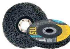
Для очистки гладких металлических поверхностей от ржавчины и краски. Для углошлифовальных машин. Благодаря специальной структуре не загрязняется и меньше нагревается в процессе работы по сравнению с традиционными абразивными материалами. Посадочный диаметр 22,2 мм. Материал: инструментальная сталь, нейлоновые волокна с абразивным слоем. Рекомендуется использовать на оборотах не более 4500 об./мин.
