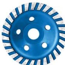
Сегментный «Турбо». Узкие сегменты. Для использования с УШМ. Посадочный диаметр 22,2 мм. Для устранения неровностей, зачистки и шлифовки бетона, камня, кирпича и аналогичных строительных материалов. Сегментированная кромка «Турбо» усиливает воздушное охлаждение и отвод отработанного материала, предотвращая перегрев диска. Материал: инструментальная сталь, режущая кромка - расправ с техническими алмазами. Упаковка: картонная коробка.
