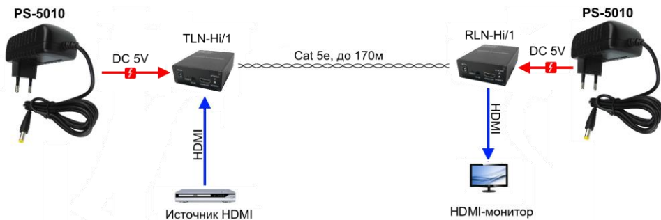
Рис.2 Типовая схема подключения блока питания PS-5010
