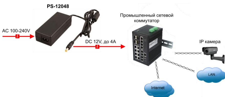
Рис.3 Типовая схема подключения блоков питания на примере PS-12048
